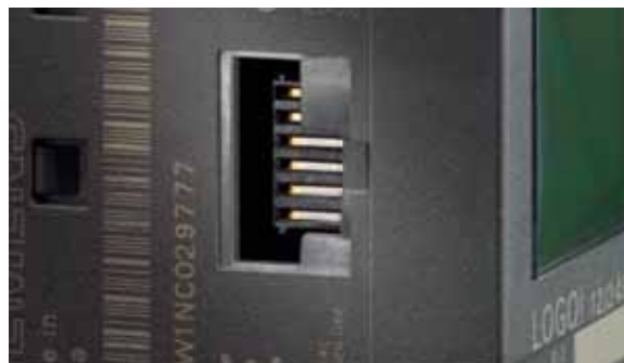
Złącze do podłączenia zewnętrznego panela tekstowego LOGO! TD
